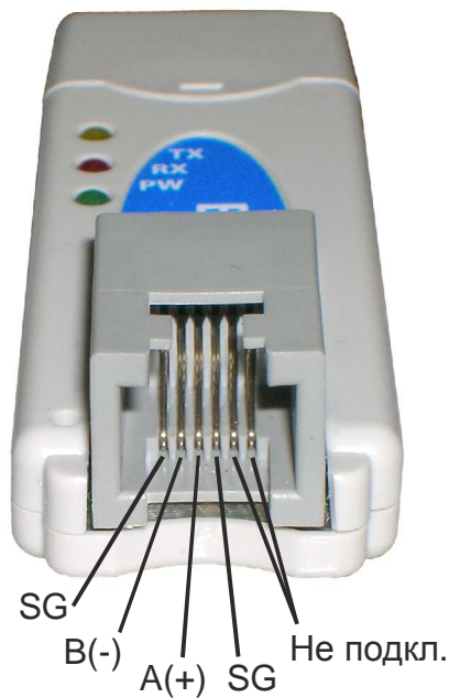
Рисунок 2 - Подключение цепей RS-485 к разъёму RJ-14
